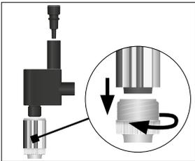
Para un funcionamiento impecable del vaporizador de espuma fina, y por motivos de higiene, es estrictamente necesario desmontarlo y enjuagarlo **diariamente** si ha preparado leche. Su JURA no va a solicitar que desmonte y enjuague el vaporizador de espuma fina.
