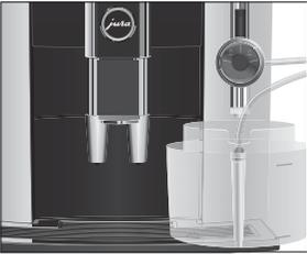
**i** Para poder conectar correctamente el tubo de leche con el depósito, el tubo de leche debe estar equipado con una pieza de conexión.
